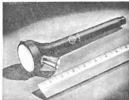
Fig. 2. - Esempio di tubo a raggi catodici per proiezione (MW6/2 Mullard) con rivestimento conduttore esterno.
