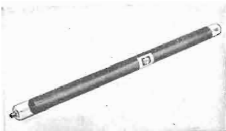
Fig. 3. - Tubo contatore di Geiger avente un elettrodo costituito da uno strato di grafite colloidale (Cinema-Television Ltd.).
